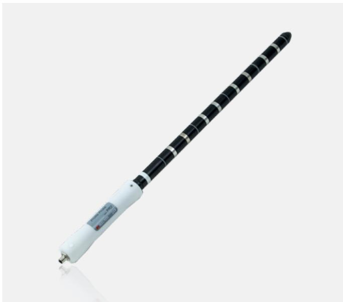
Никакая другая система измерения влажности почвы не позволяет вам с легкостью и гибкостью контролировать профили влаги в почве. Датчик для измерения влажности почвы PR2 построен на основе новой запатентованной технологии, которая обеспечивает беспрецедентную производительность для всех типов почв при минимальном влиянии солености или температуры. Модель PR2/4 измеряет влажность почвы на 4 глубинах до 40 см или PR2/6 измеряет на 6 глубинах до 100 см.
