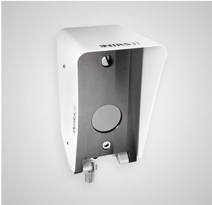
Датчик измеряет состояние поверхности дорожного полотна, такие как влажность, лёд, снег или иней, а также высоту водной плёнки, процентное содержание льда в воде и температуру замерзания. Благодаря этим измерениям датчик способен рассчитывать коэффициент трения на дороге или ВПП.
