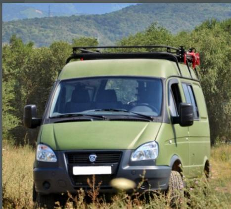
Шасси - автомобиль Соболь ГАЗ-27527, переоборудованный для работы с комплексом и дооборудованный для высокой проходимости по бездорожью и дополнительным местом для перевозки оборудования
