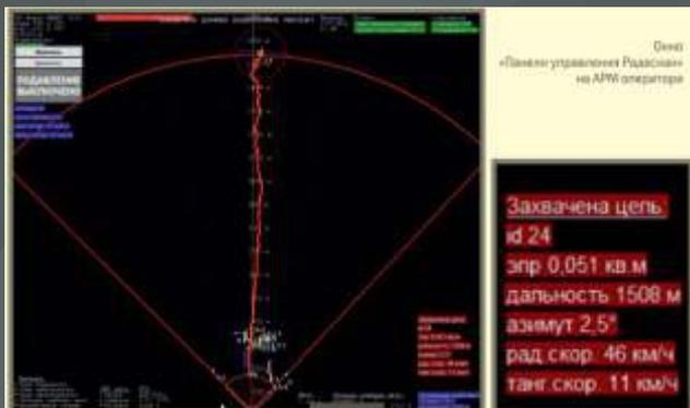
При обнаружении низколетящих объектов типа БПЛА определяются следующие данные: азимут; дальность; направление движения; ЭПР. Полученные данные позволяют строить траекторию движения цели в реальном времени и автоматически управлять поворотной платформой, на которой установлен блокиратор. Траектория движения отображается на мониторе оператора.
