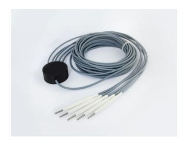
Набор датчиков профиля температуры использует 5 высокостабильных и точных датчиков РТ100 с платиновыми чувствительными элементами для измерения температуры в пяти различных точках.
